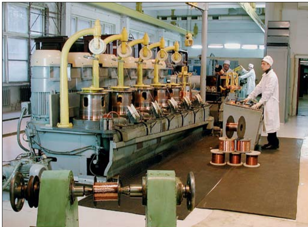
Участок тонкого волочения низкотемпературного сверхпроводящего провода на основе NbTi.
