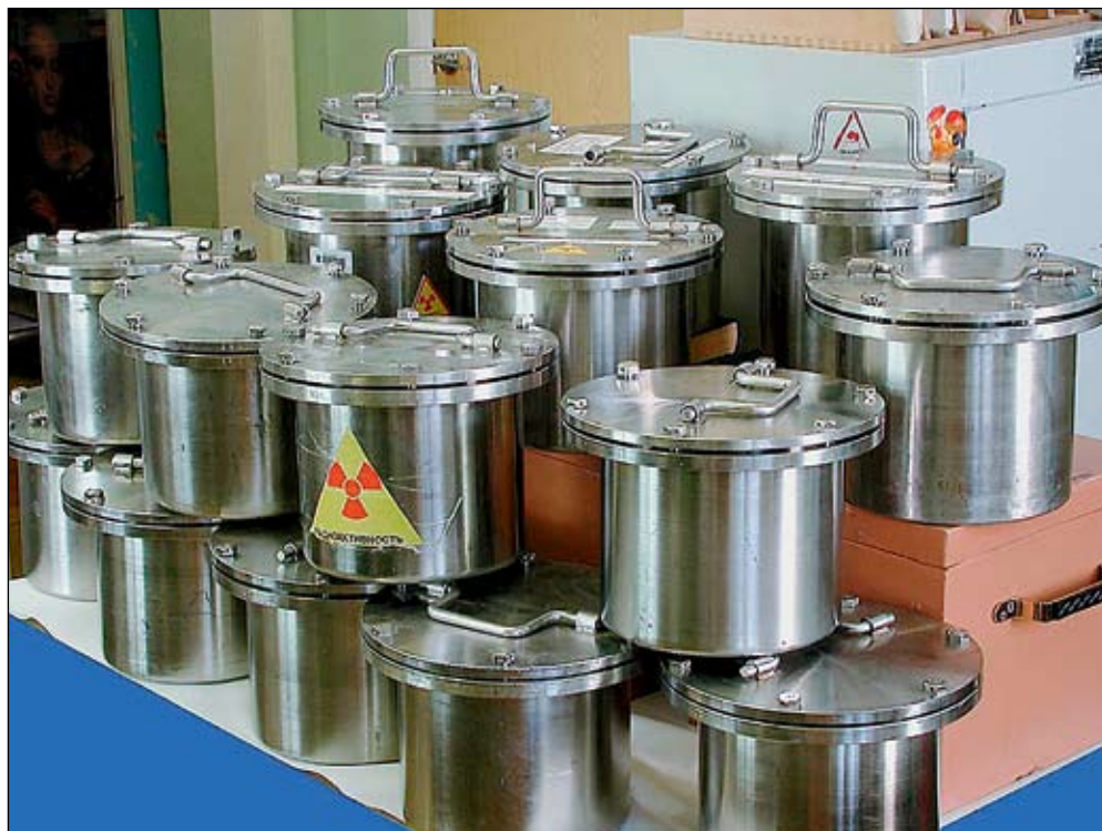
Во ВНИИНМ разрабатывают самое разнообразное оборудование для работы с радиоактивными материалами. На фото сверху — сертифицированные контейнеры для транспортировки стандартных образцов урана, внизу — бесчехловая тепловыделяющая сборка с гексагональной топливной решёткой для водо-водяных энергетических реакторов.
